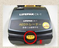
③ 次に正面のON/OFFスイッチを押し 蓋を開けると、音声ガイダンス が始まります。(必ず②→③の順番) ガイダンスに従ってシミュレーションを 進めていきます。
