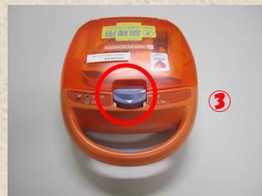
③ 正面の蓋のツメがスイッチになっているのでスライドして蓋をあけると、音声ガイダンスが始まります。
