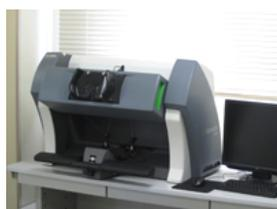
手術支援ロボット da Vinci のトレーニングシミュレーター。高解像度3Dビジョンで、術野、ペダル、マスターコントローラーが da Vinci サージカルシステムをリアルに再現。
