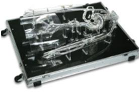
心血管系をシリコン樹脂で忠実に再現したシミュレーター。カテーテル手技教育（TRI）からカテーテルデバイス評価まで、様々な用途に応用できる。
