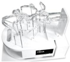
脳カテーテルトレーニングシミュレーター。MDCTにより得られた複数の画像データを融合し、忠実な血管走行の再現と、トレーニングやデバイス評価などに適した形状とを兼ね備えている。
