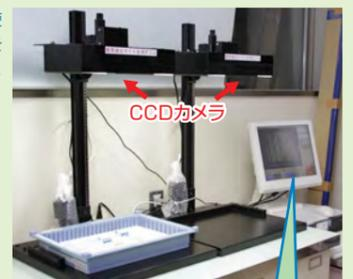
③ トレー上の空いた箇所のカラービット®コードをCCDカメラが読み取り、使用医薬品を認識して集計する。トレーに収容できない100mL以上の輸液類の使用数量は画面上で入力する。
