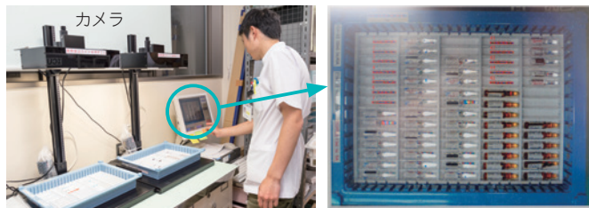
「手術室セット薬品管理システム」により、手術室で使う注射薬を自動で管理。患者個人別に医薬品が組まれたトレーには、薬剤ごとに割り振られたカラーピットコードが貼付されている。使用後に上からカメラで撮影すると、取り出されて空きになっている医薬品の場所を自動的に認識して集計する。
