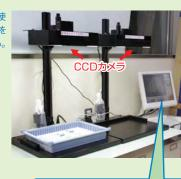
③トレー上の空いた箇所のカ ラービット<sup>®</sup>コードをCCDカメ ラが読み取り、使用医薬品 を認識して集計する。トレー に収容できない100mL以 上の輸液類の使用数量は 画面上で入力する。
